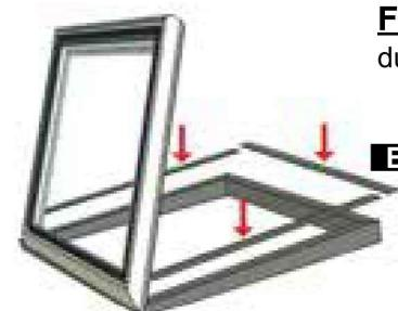
**FR** En version ouvrante, montez les protections pare-pluie sur la partie haute du profil adaptateur en fixant les petites vis dans les trous pré-percés
